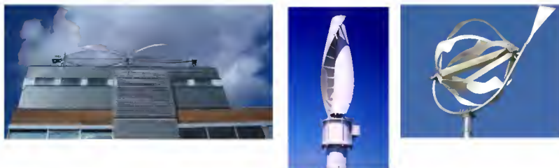
Figure 7 : Eoliennes de type Darrieus, Savonius et Venturi (de gauche à droite)
