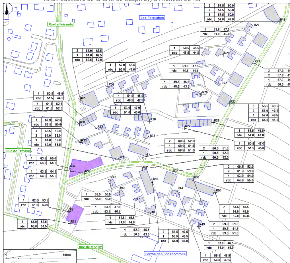
147- Contribution sonore de toutes les infrastructures (existantes et en projet) en façade des futurs bâtiments de la ZAC de Coupvray, à l'horizon 2045.
